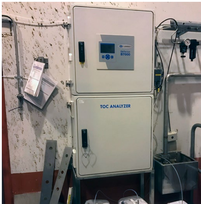
Анализатор ООУ BioTector B7000 использует технологию двухстадийного окисления для полного окисления пробы и способен работать с частицами до 2 мм.
